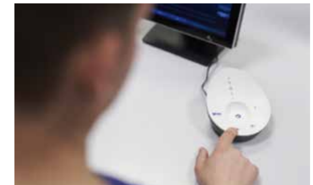
Abb. 4 Gespiegelte LED-Anzeigen auf Ladeschale und Patienteneinheit zeigen synchron an, ob die Saugintensität des Müller-Manövers passt
